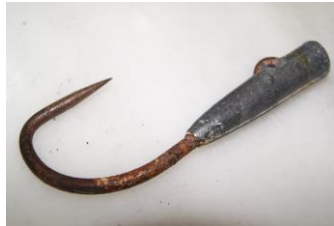
Anuelo encontrado en una cinta de corte donde puede apreciarse la marca que dejó la sierra
